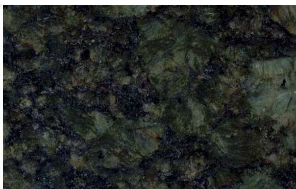
Figura 3. Granito Verde Pavão, uma rocha ornamental charnockítica representativa do Brasil, de cor verde escura (H=135, S=4.8, B=9.1). Notam-se baixos valores dos parâmetros S e B. A largura horizontal da imagem corresponde a 8 cm.
