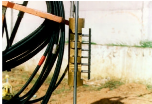
Figura 1. Fonte de energia para geração preferencial de ondas S. A massa metálica é ancorada hidráulicamente contra as paredes do furo de sondagem e uma haste metálica, que se desloca relativamente à mesma, é utilizada na geração de energia através de impactos nas suas extremidades superior e inferior.
