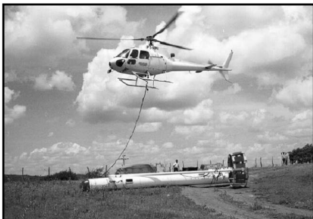
Figura 2 – Aeronave utilizada no método geofísico aeroportado destacando o “bird” que comporta os sistemas eletromagnetométrico e magnetométrico.
