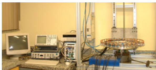
Figura 3 - Fotografia do tomógrafo ultra-sônico para testemunhos, projetado e construído neste projeto.
