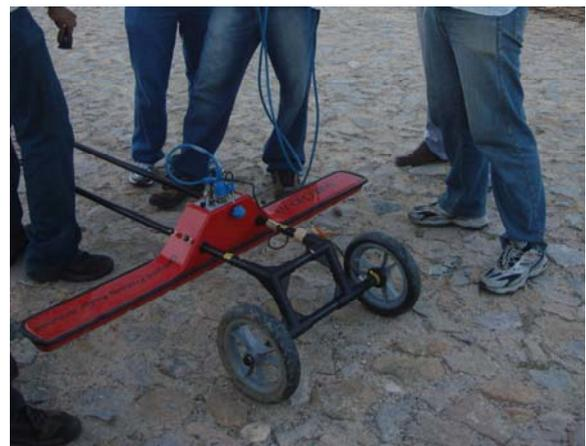
Figura 4 – Aquisição de dados GPR SIR 3000 com antena Sub-echo com frequência de 70 MHz (seção 2).
