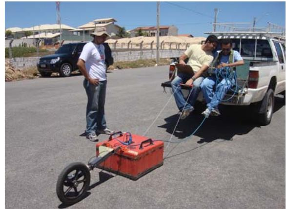
Figura 3 – Aquisição de dados GPR SIR 3000 com antena com frequência centrada de 200 MHz (seção 4).
