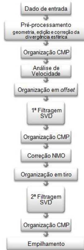
Figura 1: Fluxograma de processamento.
