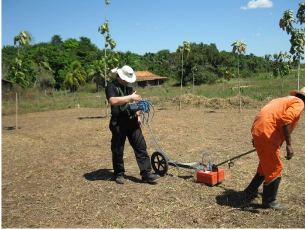
Figura 2 - Fotografia da aquisição utilizando o GPR com antena blindada de 400 MHz.
