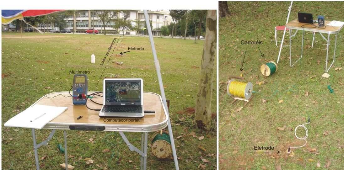
Figura 3: Levantamento de PE realizado sobre a linha de tambores metálicos do SCGR-IAG/USP.
