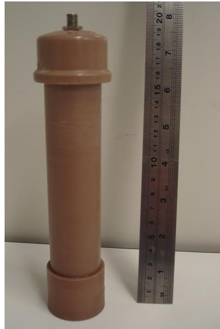
Figura 2: Imagem do eletrodo do tipo Pb-PbCl<sub>2</sub> após montagem.
