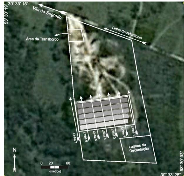
Figura 2 – Posição das linhas de Caminhamento Elétrico sobre a região das valas (Adaptado de Google Earth, 2010).
