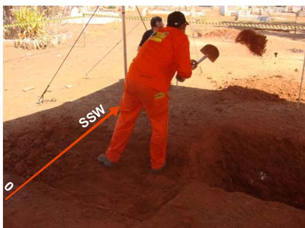
Figura 6 – Fotografia ilustrando a perfuração de alvos indicados pela interpretação das linhas GPR.
