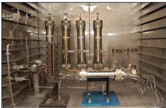
**Figura 3 – Célula para medida de deslocamento multifásico em pressão e temperatura de reservatório.**
