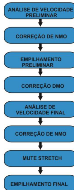
Figura 3 - Fluxograma das etapas de processamento avançado.
