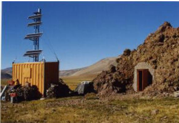
*Figura 4. Base de monitoramento no vulcão Planchon-Peteroa. Pode ser visto a câmara escavada num maciço rochoso, para abrigar os sensores, e um container para alojamento do resto da instrumentação, bem como os painéis solares para energia.*
