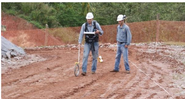
Figura 5 – Equipamento GPR empregado na investigação
