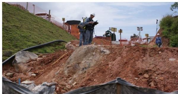
Figura 7 – Levantamento gpr em uma seção transversal ao eixo do duto
