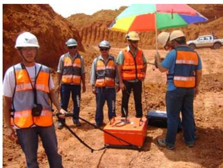
Figura 4 – Antena de GPR de 200 MHz utilizada na aquisição dos dados.
