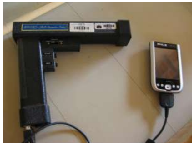
Figura 2 - Hand- Held Conductivity & Magnetic Susceptibility Meter DDD MPP-EM2S + Multi Parameter Probe utilizado no levantamento de dados.
