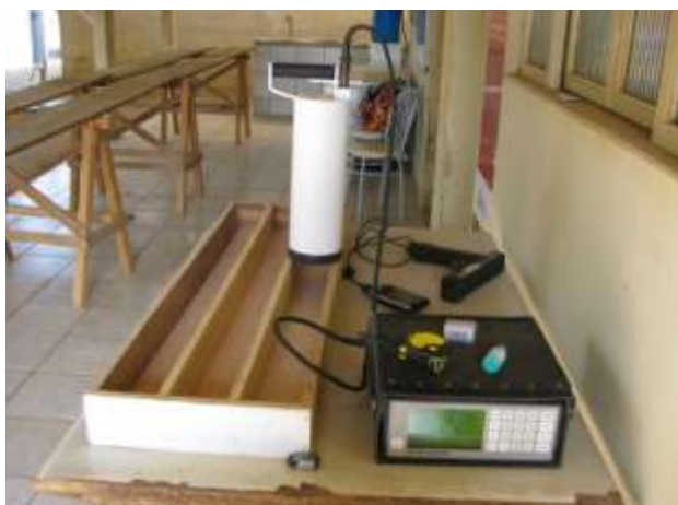
Figura 1 - Gamaespectrômetro portátil GR-320, fabricado pela Exploranium, utilizado no levantamento de dados.
