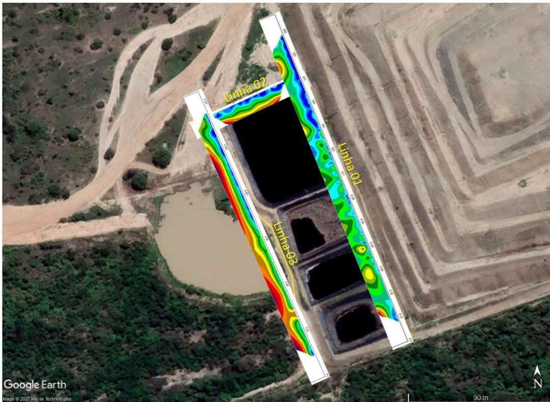
Figura 5 - Sobreposição das imagens geoeletricas georeferenciadas na imagem de satélite. Identifica-se que a região norte da área investigada se encontra mais susceptível à potencial percolação por lixiviado.
