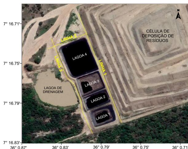
Figura 2 – Imagem de satélite mostrando a disposição da célula de deposição de resíduos, das lagoas de contenção de lixiviado e das três linhas geoeletricas.
