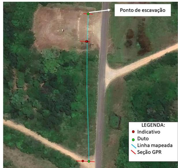
Figura 5: Localização do trecho mapeado e interpretação final do duto através do método de GPR.
