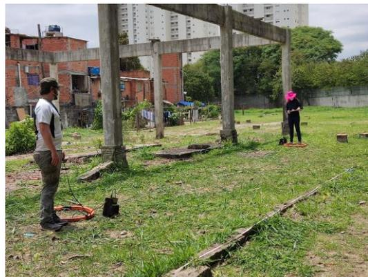
Figura 3. Levantamento eletromagnético realizado na área de estudo.
