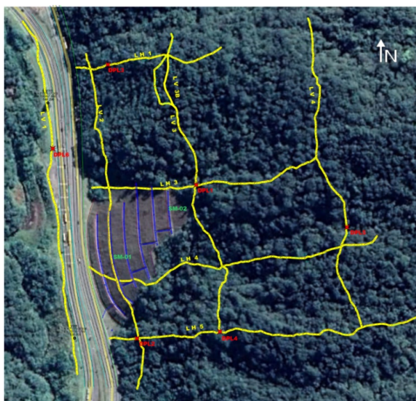
Figura 1 – Local dos levantamentos geofísicos e investigações diretas através de sondagens mistas e teste DPL.
