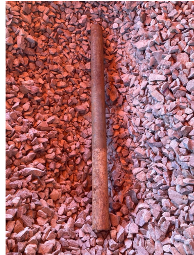
Figura 9 – Tubo metálico inserido na camada de lastro para realizar análise de velocidade.
