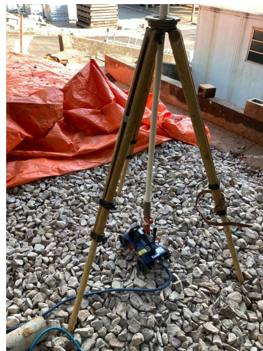
Figura 5 – Tripé de madeira utilizado para estabilizar e deslocar verticalmente a antena de 1600 MHz.
