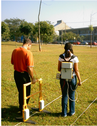
Figura 1. Aquisição de dados GPR com as antenas de 200 MHz, modo passo-a-passo.
