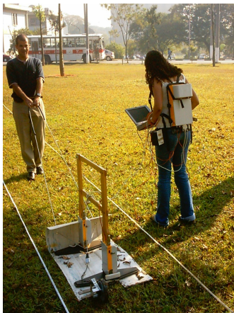
Figura 2. Aquisição de dados GPR com as antenas de 200 MHz, modo contínuo.
