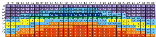
Figura1- Modelo geológico de uma dobra anticlinal discretizado
