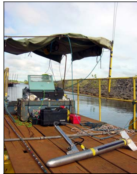
Foto 1: Vista dos equipamentos geofísicos. Em primeiro plano, o transdutor ("peixe"); ao fundo, o registrador Klein.
