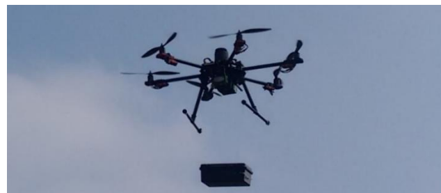
Figura 3 – Acoplamento do data-logger ao drone, com auxílio de fio de nylon.
