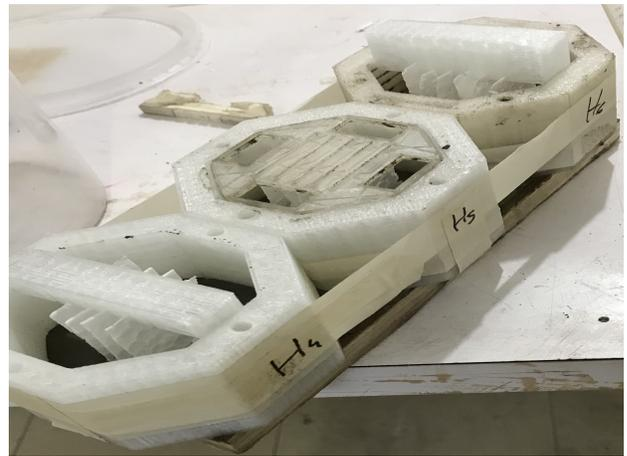
Figura 3: Tiras quadradas de isopor dispostas no interior das amostras durante o processo de construção. Elas dão origem aos espaços vazios representativos de fraturas.
