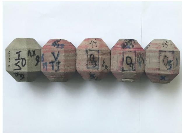
Figura 4: Rochas em escala reduzida utilizadas no trabalho. É possível ver que suas formas possibilitam aquisição de ondas P diagonalmente.
