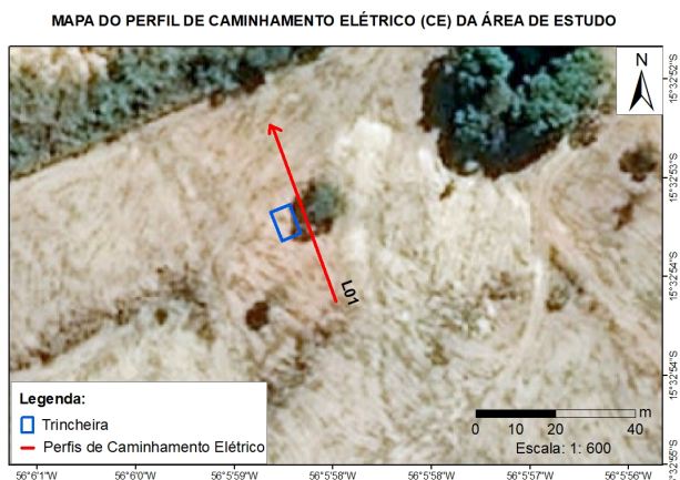
Figura 02. Mapa com o perfil L01 disposto na direção NW-SE paralelamente com a trincheira. A seta vermelha indica o sentido do caminhamento elétrico. O retângulo em azul representa a trincheira e possível nascente aterrada.
