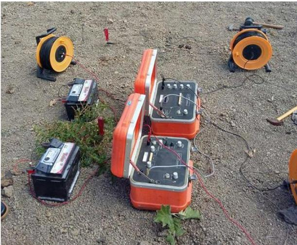
Figura 2 – Equipamentos utilizados na aquisição dos dados de eletrorresistividade.
