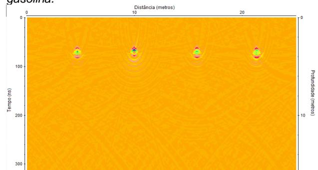
Figura 8 – Seção radargrama com migração Kircchoff. PVC, aço, concreto e cerâmica (em ordem da esquerda para a direita).
