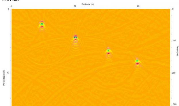
**Figura 18** – Seção radargrama com migração Kircchoff. PVC, aço, concreto e cerâmica (em ordem da esquerda para a direita).
