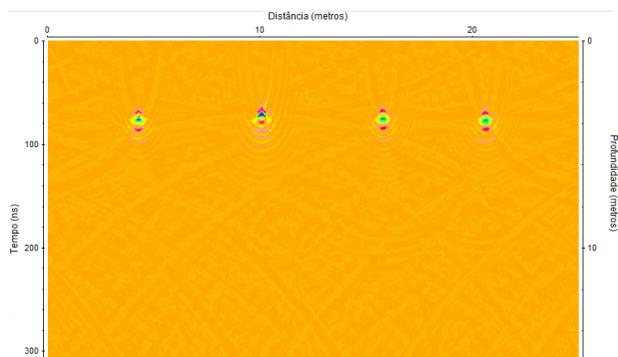
Figura 11 – Seção radargrama com migração Kirchoff. PVC, aço, concreto e cerâmica (em ordem da esquerda para a direita).
