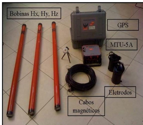
Figura 5: Sistema de aquisição MTU-5A fabricado pela Phoenix Geophysics do Canadá.
