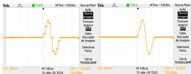
Figura 7 – Sinal transmitido *Tone Burst*, com a Taxa de 4MS/s à esquerda e 40MS/s à direita.
