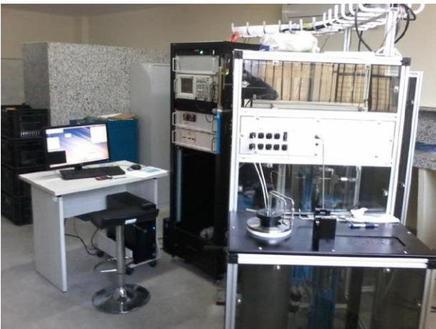
Figura 2 – Equipamento *Autolab 500*<sup>®</sup> utilizado para a medição convencional das velocidades elásticas.
