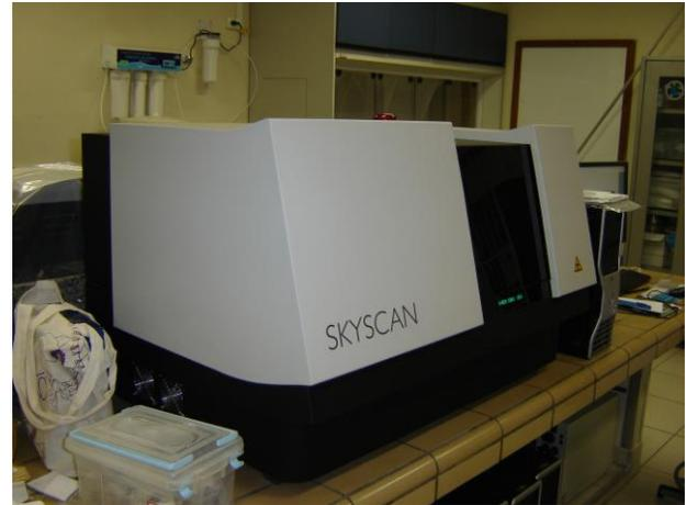
Figura 3 – Microtomógrafo *Skyscan 1173*<sup>®</sup>.
