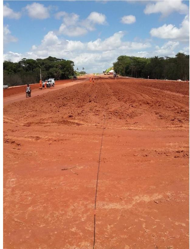
Figura 5 – Vista geral do aterro mostrando o cabo que conecta eletrodos no levantamento do CE 03.
