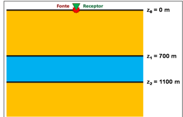
Figura 6: Modelo geológico e arranjo fonte-receptor utilizados para simulação do caso de baixas frequências
