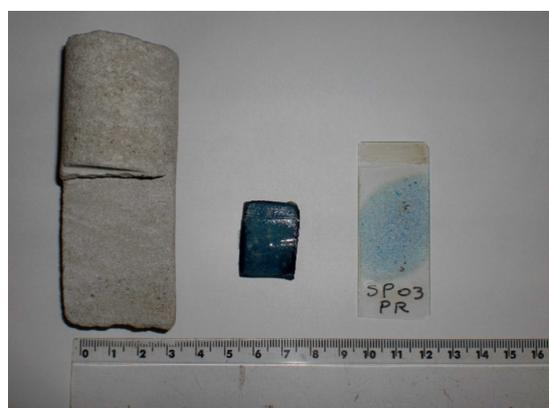
**Figura 2.** Plugue da rocha consolidada SP-03-PR; resina epóxi azul; lâmina delgada após o processo de impregnação da resina em seus poros.
