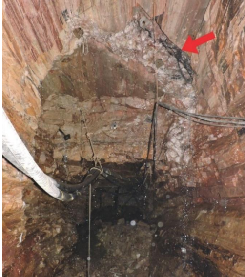
Figura 5 - Veios de quartzo com óxido de manganês (seta vermelha) no entorno das galerias subterrâneas. Extraído de Mineração Curral de Pedra, 2017.
