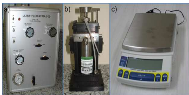
Figure 2: a) Permporosímetro; b) Matrix cup; c) Balança semi-analítica (Gurjão et al., 2013).
