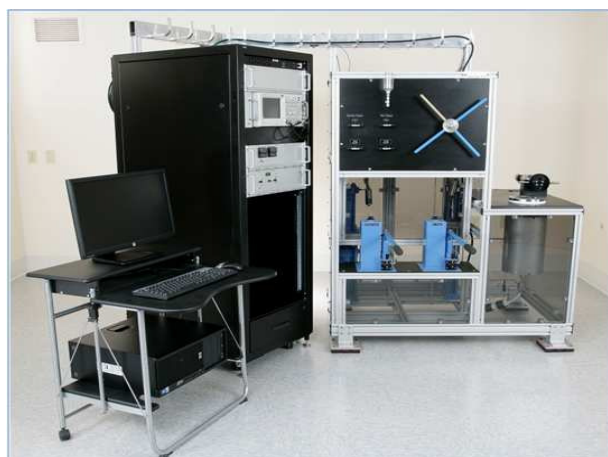
Figure 3: Sistema Autolab500 da UFCG. Utilizado para mensurar as propriedades elásticas da rocha (Gurjão et al., 2013).
