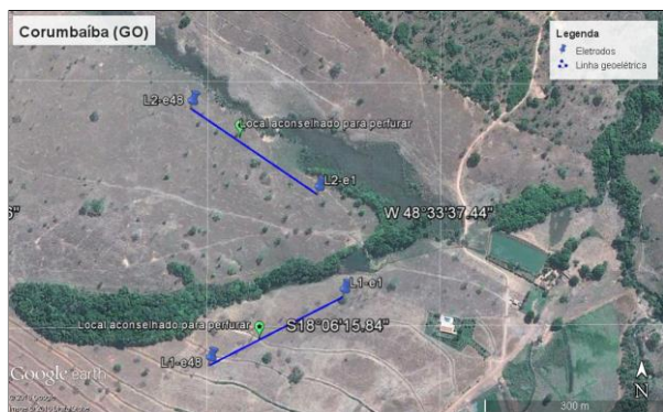
Figura 2 – Disposição das linhas geolétricas 1 e 2 na indústria de laticínios em Corumbaíba (GO) com as indicações dos locais para perfuração dos poços.
