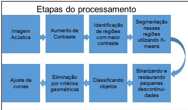
Figura 1 - Esquema representa os processos executados pelo código de detecção de fraturas.
