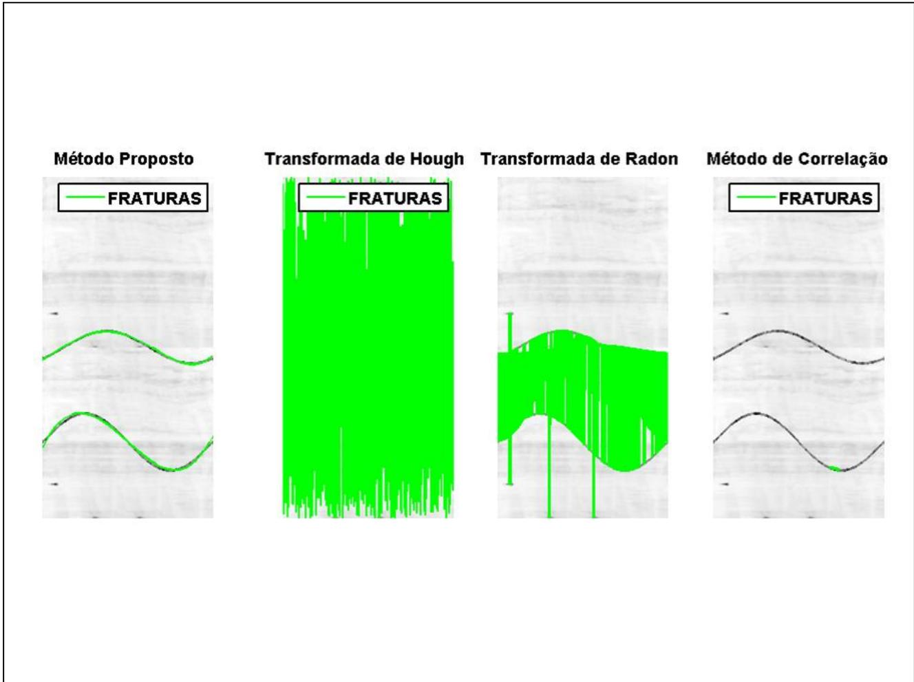
Figure 4 – Exemplo de resultado obtido por cada método. A linha em verde delimita as fraturas encontrada por cada método. O proposto conseguiu detectar com sucesso as fraturas na imagem sintética, obtendo um coeficiente de correlação entres os dados e a curva superior a 0.9, bem próximo a 1 o melhor valor de ajuste. Os demais não foram capazes de detectar as fraturas devido ao baixo contraste com o fundo.
