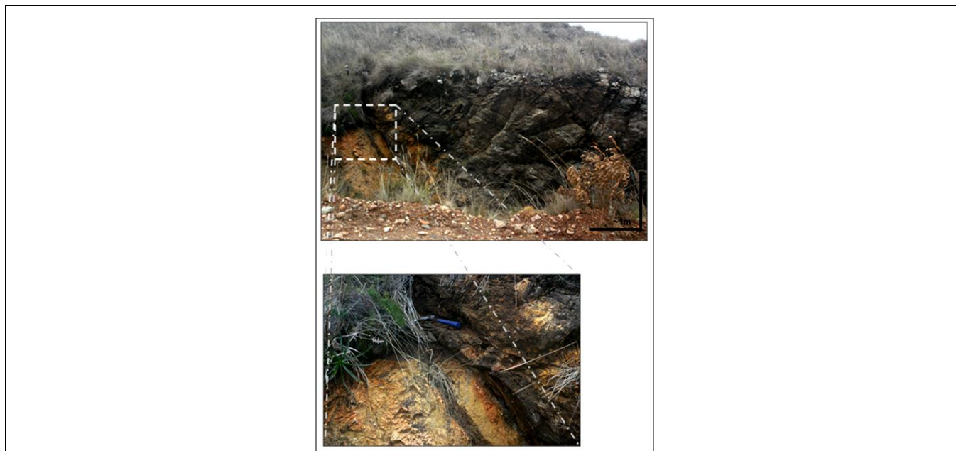
Figura 9 – Imagem do afloramento mostrando o contato entre os serpentinitos e os gnaisses do embasamento metamórfico. Posicionamento: -53,9926 W - -30,2954 S. Descrição: Serpentinito, K médio: 46,25 ( 10^{-3} SI).
