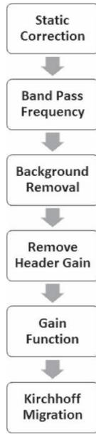
Figura 1 – Fluxo de processamento aplicado aos dados de GPR.
