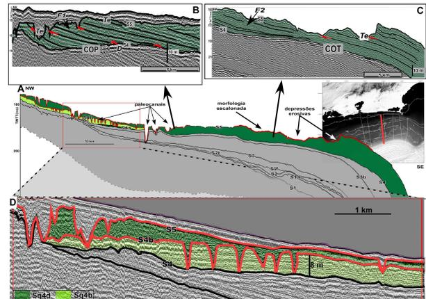
Figura 4 – Exemplo de interpretação da sequência sísmica Sq4 em perfil sísmico Sparkler (A), destacando duas fácies sísmicas identificadas: F1, em B, representando cliniformas oblíquas-paralelas (COP) e F2, em C, constituindo cliniformas oblíquas-tangenciais (COT). Destaque para diferentes gerações de paleocanais (D).
