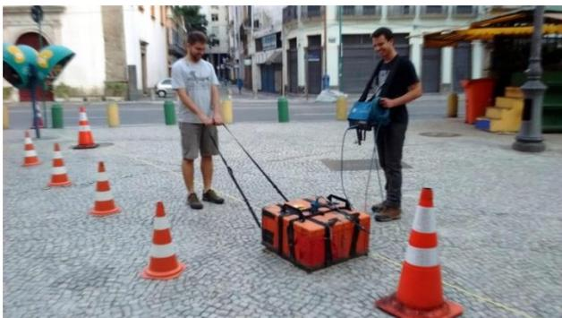
Figura 6 - Equipamento TerraSIRch SIR System-3000.
