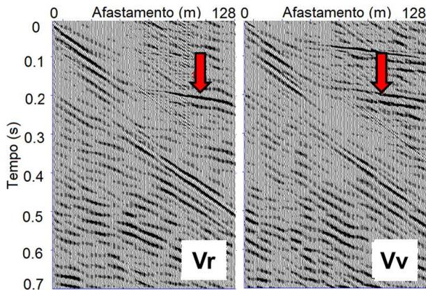
Figura 7 – Dado sísmico adquirido na área de estudo e processado com o intuito de preservar a presença de energia de onda PSv. Os eventos de onda PSv estão indicados com setas vermelhas.
