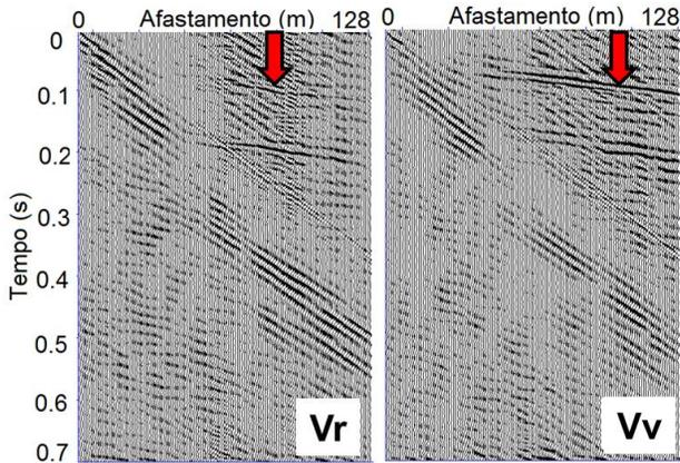
Figura 6 – Dado sísmico adquirido na área de estudo e processado com o intuito de preservar a presença de energia de onda P. Os eventos de onda P estão indicados com setas vermelhas.
