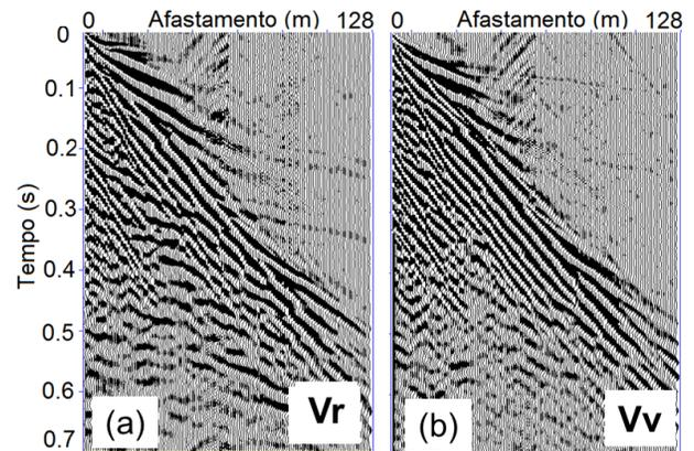
Figura 5 – Registro sísmico bruto adquirido na área de estudo: (a) Fonte Vertical – Receptor Horizontal Radial; (b) Fonte Vertical – Receptor Vertical.
