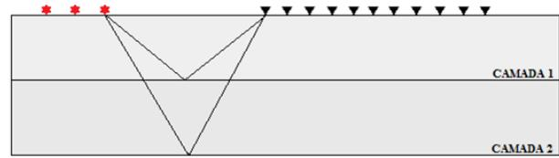
Figura 4 – Ilustração esquemática de geometria de teste de Análise de Ruído com receptores fixos.
