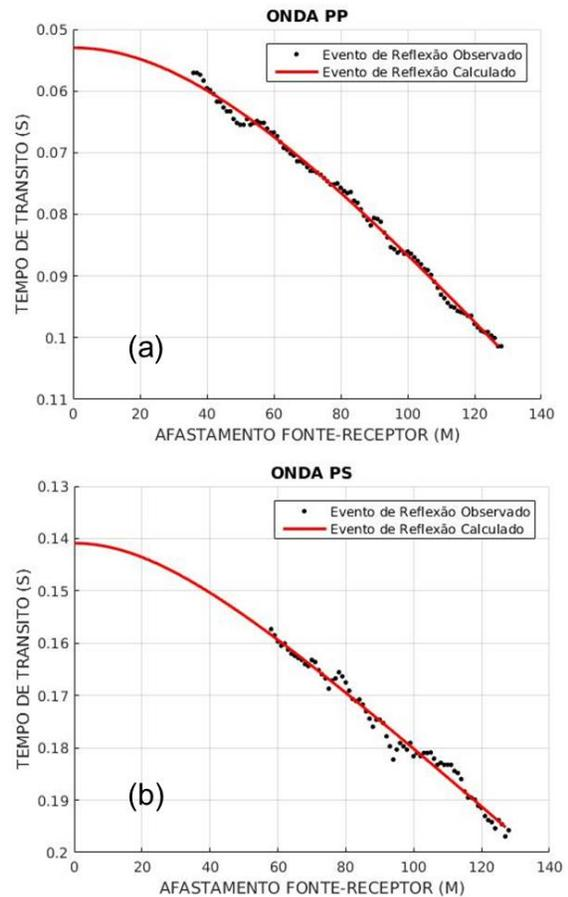
Figura 8 – Tempos de trânsito observados (pontos pretos), e os tempos de trânsito obtidos pela inversão (curva vermelha): (a) Onda PP; (b) Onda PSv.
