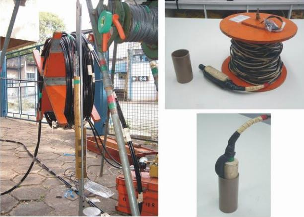
Figura 4 - Fonte de onda cisalhante (esquerda); geofone triaxial de furo (direita).
