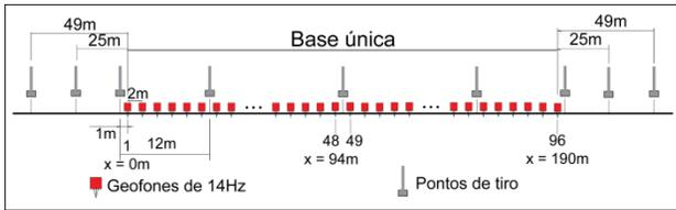
Figura 1: Arranjo de aquisição de campo com 96 geofones, espaçamento de 2 metros e ponto de tiro a cada 12 metros.
