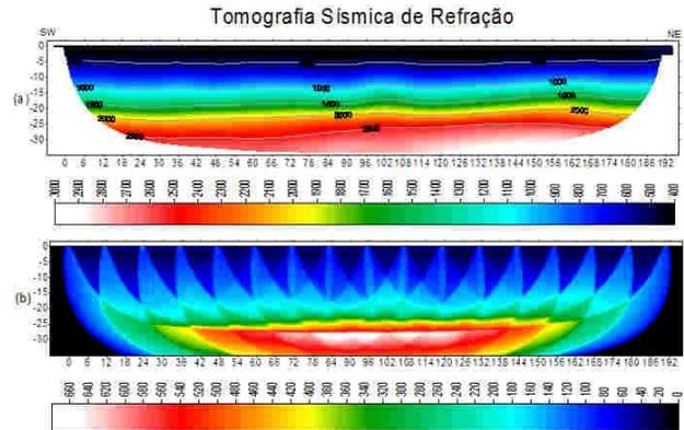
Figura 2: Seção de tomografia sísmica de refração (a) e densidade de raios dos tiros dados ao longo da seção sísmica.
