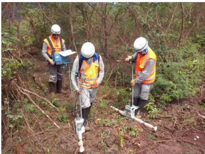
Figura 2: Levantamento Seção GPR com antena 80 MHz.
