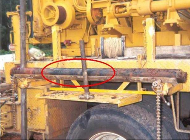
Figura 1 - Amostra de solo contaminada por HC.
