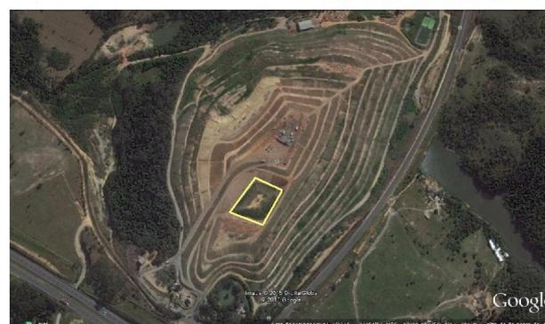
Figura 1 – Localização esquemática do aterro sanitário Delta A, próximo a Rodovia dos Bandeirantes, com destaque para a célula experimental no topo do aterro, com as linhas de perfil realizadas com o arranjo dipolo-dipolo, espaçamento entre eletrodos de 5 m para as linhas C3 e C4, e de 2,5 m para a C5.
