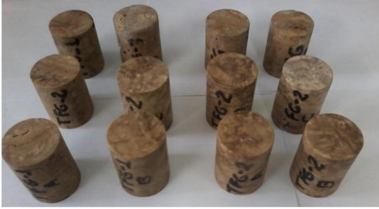
Figura 3 – Exemplo de amostras de tufa carbonática preparadas para os ensaios petrofísicos.
