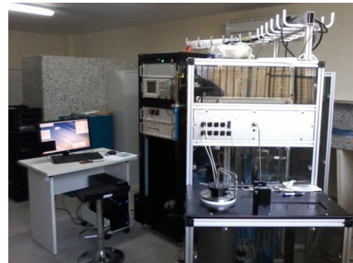
Figura 5 – Câmara de medição de velocidades de ondas elásticas sob condições controladas de pressão e temperatura.
